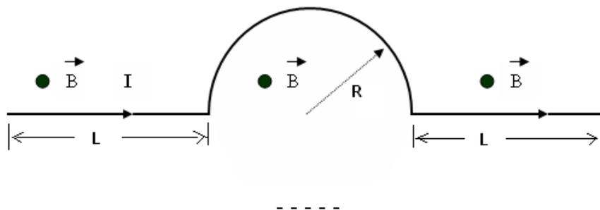
El alambre lo podemos dividir en tres tramos: el primero rectilíneo de longitud  $L$ , el segundo una semicircunferencia de radio  $R$ , y el tercero nuevamente rectilíneo de longitud  $L$ . Entonces la fuerza total será:
