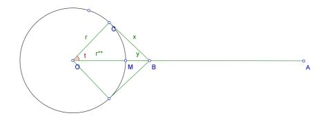
Si tiramos del extremo A de la cuerda, nos alejaremos de O, de manera que la distancia entre nosotros y la columna llegará a ser máxima. Es sensato maximizar la función z=AM.
